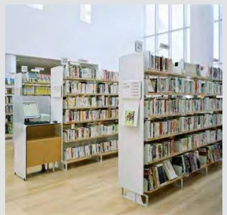
一般書架：手に触れる棚を木製にしたスチール混合書架。足元を特に補強。サイン、展示台、ブックエンド、棚の変換性など、機能性をシステムデザイン
