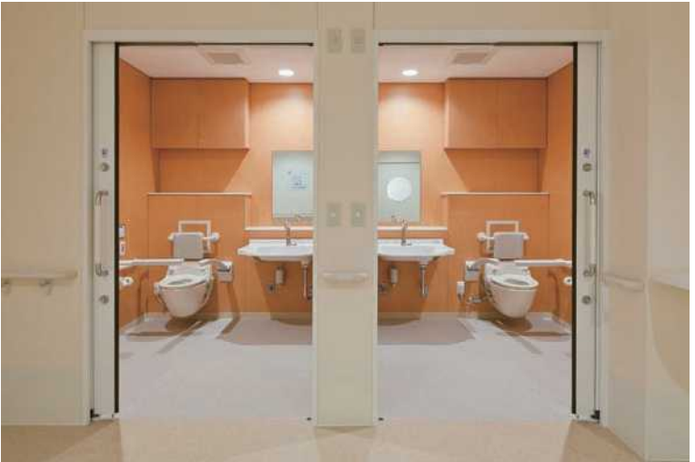
左右いずれの片麻痺にも対応できるようにトイレは二対で整備
